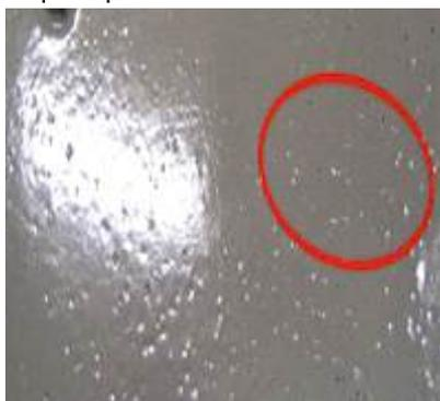
Нанесение смеси на влажный или недостаточно очищенный бетон.
